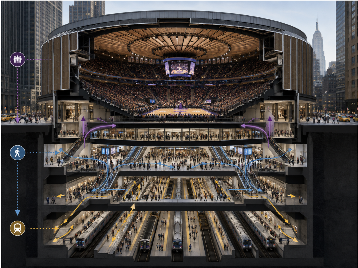
그림 2. 경기장, 대합실, 승강장, 보행 흐름이 수직으로 겹치는 MSG-Penn Station 구조의 개념 단면
